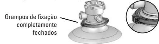
FIGURA 4 - Instalação do grampo de fixação
