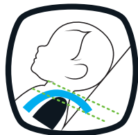
Orientación hacia atrás (arnés A NIVEL DE o justo debajo de los hombros)
