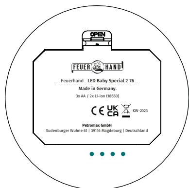
Fig. 1.3 : Stängt batterifack med laddningsindikator i upp till 5 sekunder efter idrifttagning
