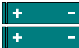
図2 - 18650リチウムイオンバッテリー2本、3.7V
