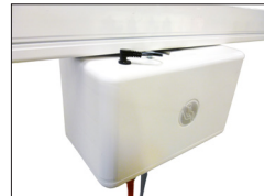
Abb. 5: Anschluss des Kabels vom Fahrwagen am Hubmotor
