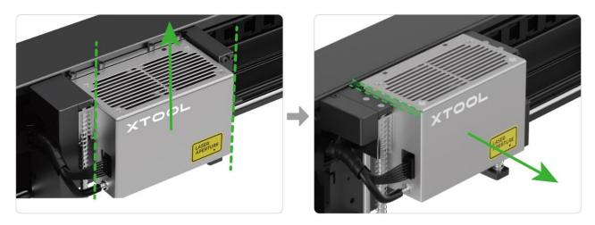
N'inclinez pas le module laser lorsque vous le retirez. Sinon, la broche de positionnement risque de rester coincée dans la fente.
