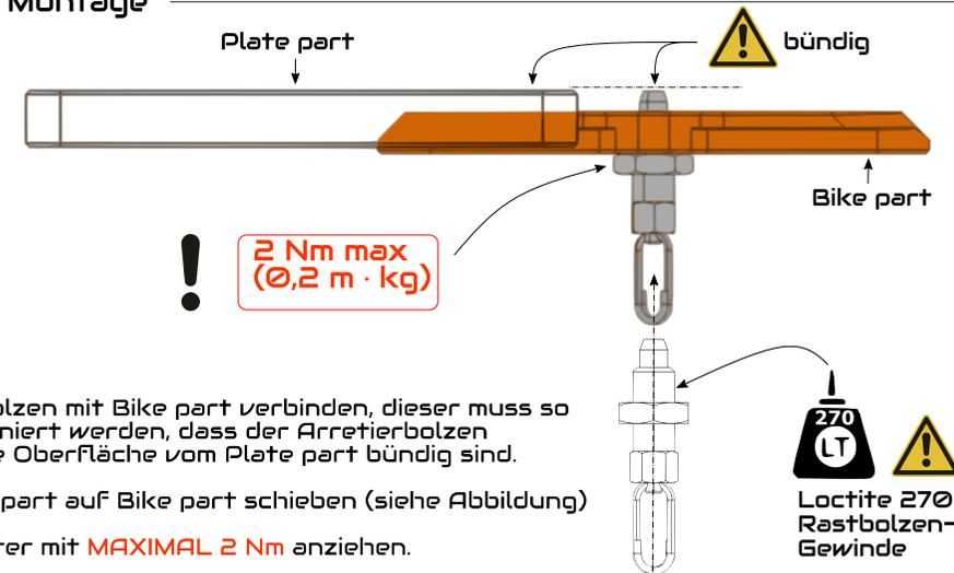
**!** Rastbolzen mit Bike part verbinden, dieser muss so positioniert werden, dass der Arretierbolzen und die Oberfläche vom Plate part bündig sind.
