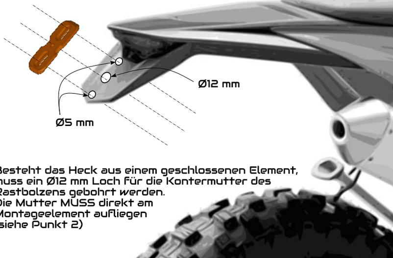
Besteht das Heck aus einem geschlossenen Element, muss ein Ø12 mm Loch für die Kontermutter des Rastbolzens gebohrt werden. Die Mutter MUSS direkt am Montageelement aufliegen (siehe Punkt 2)
