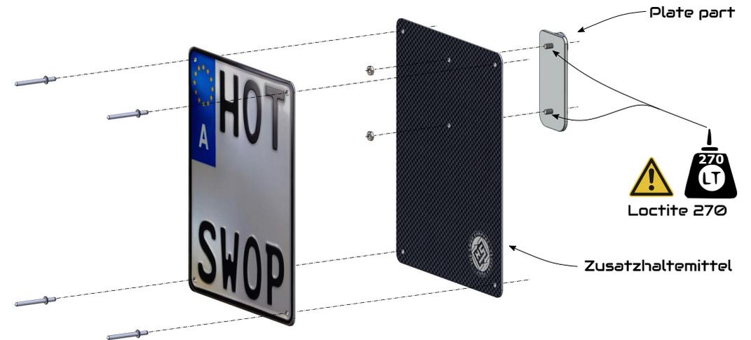
**!** Bei Verwendung von Zusatzhaltemittel (Kennzeichenhalterung, Alu oder Carbonplatten\* etc.) muss insbesondere darauf geachtet werden, dass die Max. zulässige Traglast des Plate parts von 0,2 Kg nicht überschritten wird.
