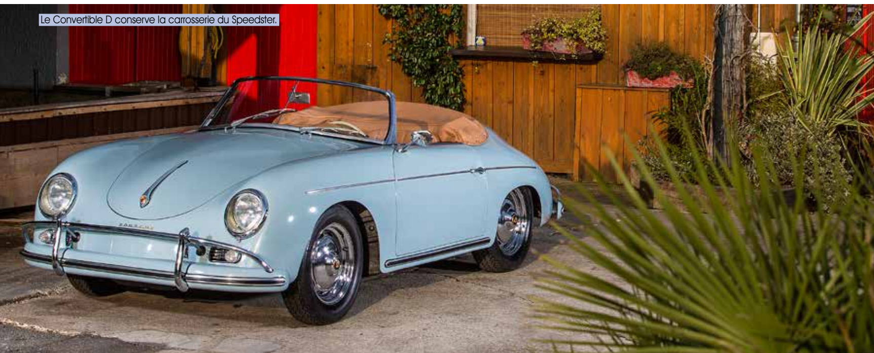
Génération B: les phares sont plus hauts, dans de nouvelles ailes.
