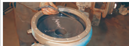
La pasta epóxica se emplea para reconstruir las áreas desgastadas en la voluta.
