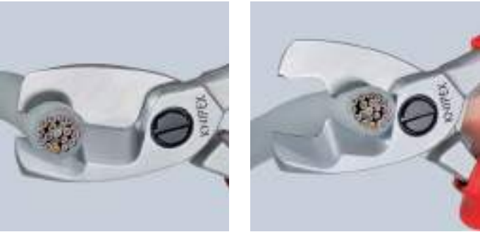
Corte inicial: Al utilizar el filo delantero para cortar el revestimiento aislante con diámetros de cables mayores, se mantiene una ergónomica apertura del mango Corte final: Después de haber cortado el aislamiento del cable con el filo delantero, los conductores se cortan en el perfil trasero. Corte inicial delante, corte final atrás – de este modo se corta con más facilidad
