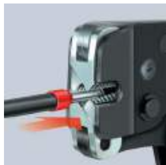
Acceso frontal en punteras Ej: conmutadores
