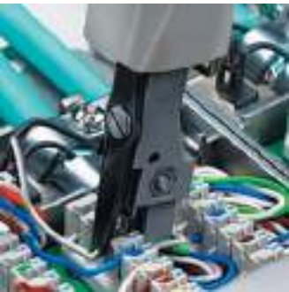
Corta y presiona en una sola operación
