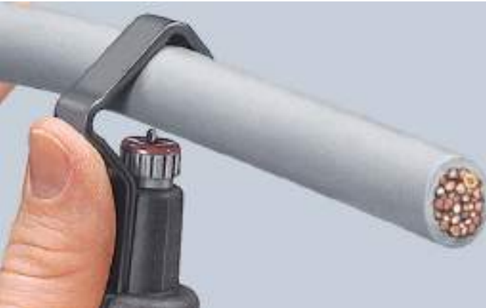
Colocar la herramienta para corte circular
