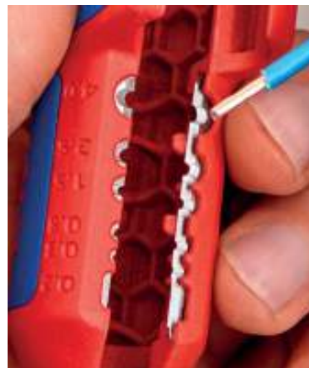
Retirar el aislamiento de conductores individuales
