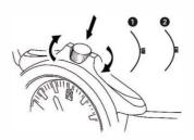
WICHTIG: Nach jeder Änderung der Uhrzeit oder des Datums, die Krone unbedingt wieder festschrauben, um die Dichtigkeit der Uhr zu gewährleisten. Bitte wenden Sie <u>niemals</u> Gewalt oder Werkzeuge an, um die Krone zu lösen bzw. wieder zu
