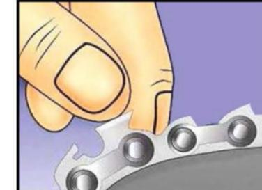
3. 將銼刀置於削蹄刀鏈的缺口、碳化鎢齒鏈的前端，銼刀的彎曲部分應和碳化鎢齒鏈的彎曲部分吻合；銼刀的頂端也應和碳化鎢齒鏈的頂端相容，削尖時握住的角度請和原本碳化鎢齒鏈呈現的角度相同。
