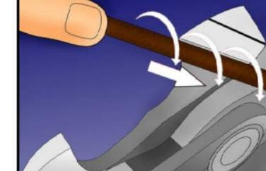
5. 檢查碳化鎢齒鏈的缺口是否乾淨，各齒鏈應削尖至約2.54毫米，若過長請再持續削尖。
