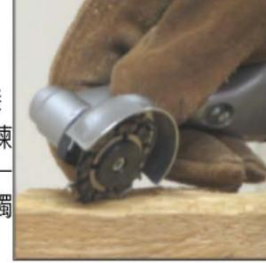
\*請以正確的方式握住削蹄器，使削蹄刀鏈與木頭呈45°到85°之間。削蹄時，請溫柔的將削蹄器按壓在木頭上，好比您在修動物腳蹄一般。另外請注意，大部分的削剪過程會像是「磨」過去的，而非像在劈砍木頭一樣。
