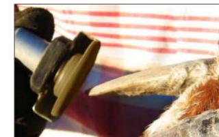
\*Hoof Boss削蹄器亦可以削羊角，削的方式和削蹄一模一樣。
