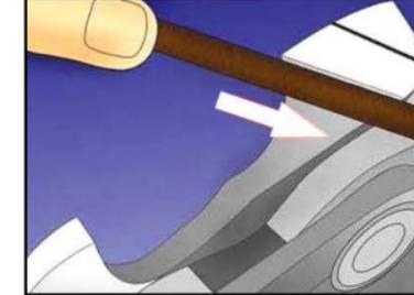
4. 將銼刀削過碳化鎢齒鏈的表面，以來回旋轉的方式來磨去金屬碎片。另外，請用手握住大部分銼刀，手指按壓短的一邊來削尖。
