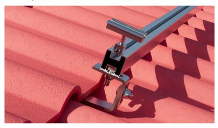
Für einen Höhenausgleich bei geschweißten Dachhaken können u.a. Unterlegscheiben zwischen Dachhaken und Montageschiene verwendet werden.
