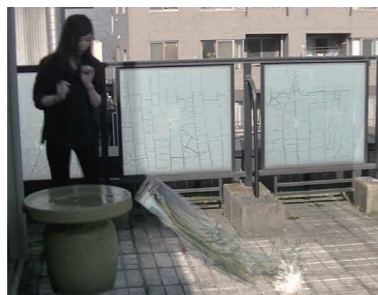
② コンクリートタイルの床面に経口部から衝突！結果はいかに・・・？
