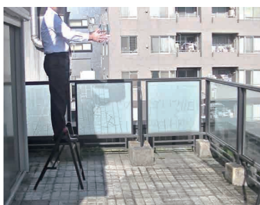
① 10ℓの水を入れた商品を2mの高さから落させてみます。
