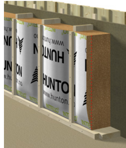
Illustrationen visar vägg blåsiserad med Nativo® träfiberisolering.
