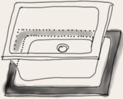
Comprovar que o lava-louça encaixe sem tocar nas zonas de agarre e sem orifício de luz visível. Para isso, usar a medida do lava-louça sobre o orifício, ou com o molde fornecido, no caso dos que são fornecidos. Todos os moldes não incluídos nas caixas, podem ser descarregados através da página web [www.poalgi.es](http://www.poalgi.es)
