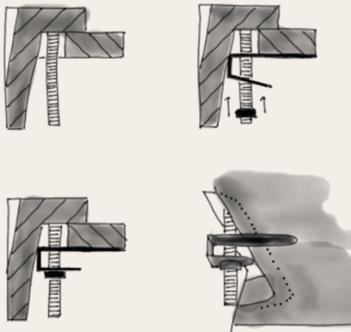
Voltar a colocar imediatamente o lava-louça no local asignado. Depois colocar as zonas de agarre sobre os parafusos que tinham sido colocados e apertar a rosca até ficar firme.
