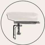
Presentar el fregadero en su posición definitiva y colocar el soporte de anclaje sobre las escudras fijadas. Mediante los tornillos de regulación ajustar la barra hasta que el fregadero quede sujeto. Comprobar por la parte superior que la posición es la deseada y, si es necesario, ajustar de nuevo el anclaje.
