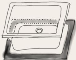
Vérifier que l'évier s'encastre en recouvrant parfaitement l'emplacement prévu à cet effet et en laissant les zones de fixation accessibles. Pour cela, utiliser l'évier ou le agarit de découpe, si celui-ci est fourni. A défaut, tous les gabarits peuvent être demandés sur le site [www.poaigi.es](http://www.poaigi.es)
