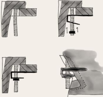
Remettre immédiatement l'évier dans l'emplacement délimité. Placer ensuite les pattes de fixation dans toutes les tiges filetées déjà fixées et serrer l'écrou pour obtenir une prise ferme.
