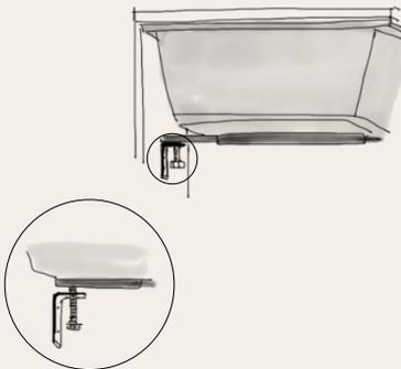
Présenter l'évier dans sa position définitive et placer la barre de soutien sur les équerres fixées. Grâce aux vis de réglage ajuster la barre jusqu'à ce que l'évier soit soutenu. Vérifier, par la partie supérieure, que la position de l'évier est correcte et si nécessaire, ajuster à nouveau la barre de soutien. Cette dernière est prévue pour soutenir l'évier et non pour le bolque contre le plan de travail.
