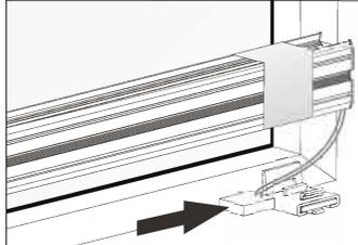
Zuerst die unteren Spannschuhe des Plissees mit den unteren Klemmträgern verbinden. (rechts und links)
