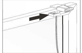
Zum Schluß die oberen Spannschuhe des Plissees mit den oberen Klemmträgern verbinden. (rechts und links)
