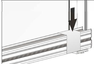
Danach das gesamte Paket auf die unteren Klemmträger schieben und die oberen Schnüre des Plissees (links und rechts) nach oben spannen. **Gegebenenfalls die Schnüre kürzen**
