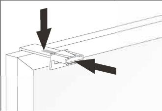
Schutzfolien von den Klebepats entfernen und alle 4 Träger in gewünschter Position auf dem Fensterflügel aufstecken und festdrücken.
