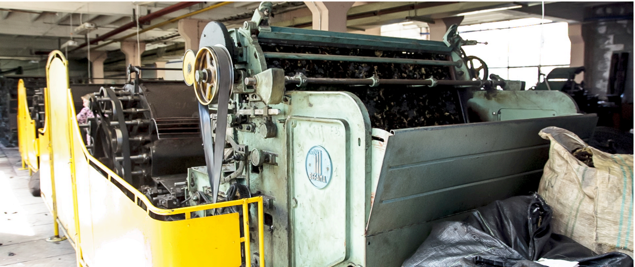
Die gereinigte Wolle wird in mehreren Arbeitsschritten zerfranst.
