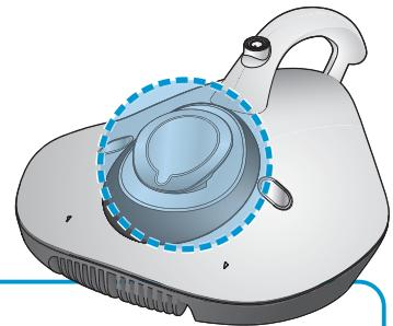
1 ダストボックスを図のように引き抜きます。
