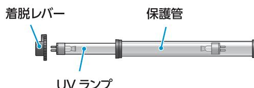
**4** 取り外しと逆の手順で、新品のUVランプセットに着脱レバーを取り付けてから、ゴムを型にあわせてしっかりとはめ、カチッと音がして緑色の表示が見えるまで、手で90度回転させて本体に取り付けます。
