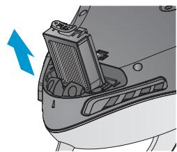
**3** 取り外しと逆の手順で、新品のマイクロフィルターを取り付けます。
