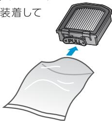
**4** 矢印方向を確認してから、マイクロフィルターカバーを閉じてください。
