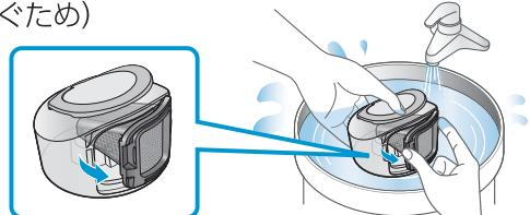
3 表面のハウスマストを取り除き、標準フィルターとダストボックスを流水で洗い流します。
