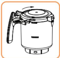
**Étape 2:** Retirez la tasse de l'appareil en faisant pivoter la poignée dans le sens horaire et en la soulevant. Ouvrez le couvercle de la tasse en tournant dans le sens horaire. Couper la nourriture en petits cubes, placez les cubes le panier de vapeur et remettez le couvercle. L'unité peut traiter des fruits, des légumes, de la viande, de la volaille et du poisson - assurez-vous simplement qu'ils sont coupés en morceaux suffisamment petits. Attention à ne pas remplir excessivement.
