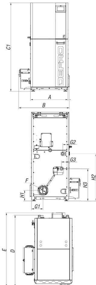
ABMESSUNGEN DES PELLETKESSELS (mm)
