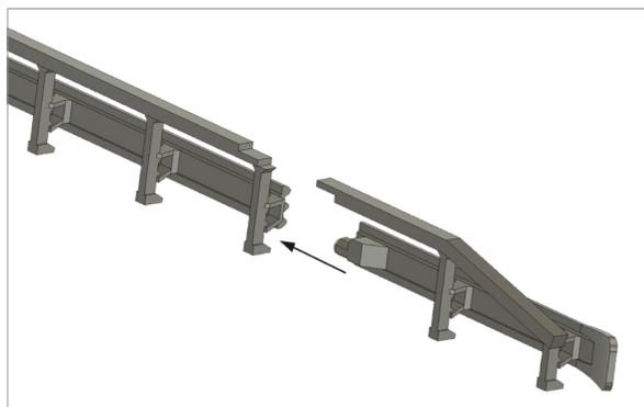
Ogni sezione e parte terminale è dotata di ganci e incastri per facilitare un preciso posizionamento dei pezzi.
