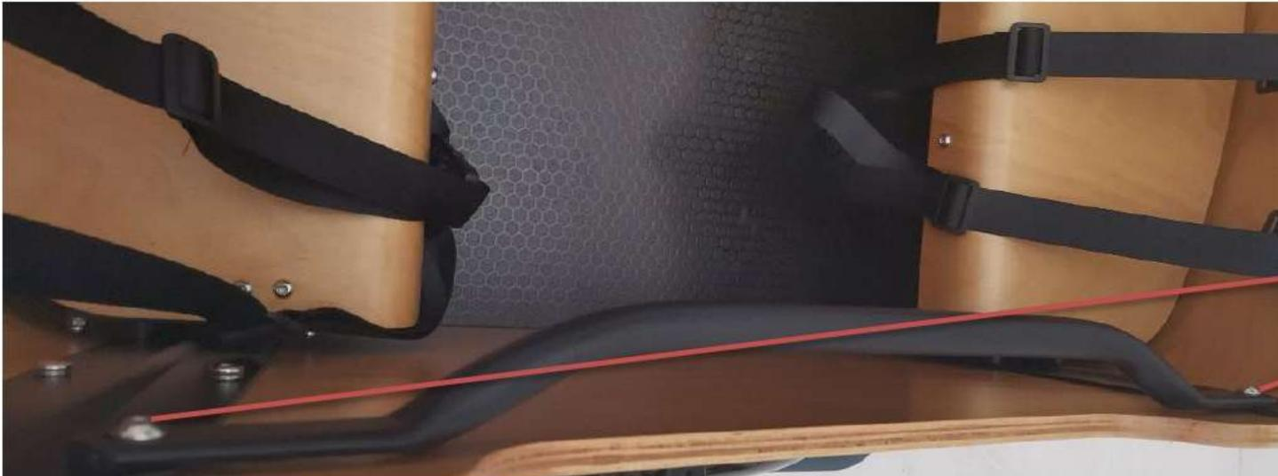
Fissaggio palaustre verso l'interno con M8x30 (Bag 15)
