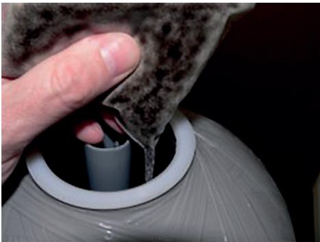
Falls keine Abdeckung auf dem Mittelrohr vorhanden ist, dieses abdecken.
