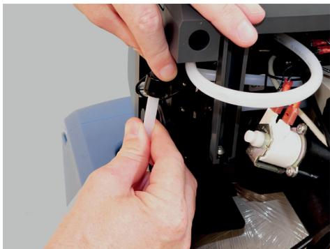
Soleschlauch vom Inneren des Regeneriermittelbehälters durch die Bohrung nach außen führen und bis zum Anschlag (ca. 15 mm tief) in den Anschlusswinkel einstecken.
