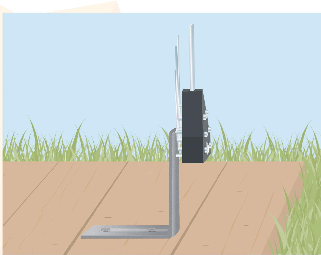
**NL:** Deze set is te gebruiken voor de installatie van een SunnyTent op een harde ondergrond, zoals steen, tegels, hout en beton. Let op: De harde ondergrond dient **minimaal 5 cm** dik te zijn om uw SunnyTent veilig te kunnen installeren.
