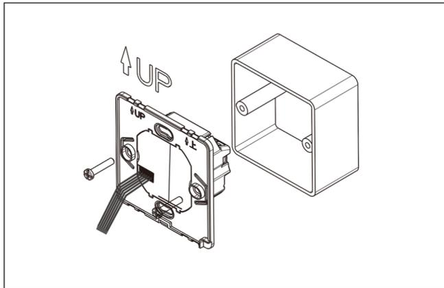
4) Remettez en place le couvercle avant par le biais de la connexion à encliquetage.
