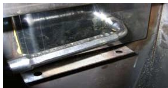
15. Skruva ur M5-skruven med hylsnöckeln på 8 mm
