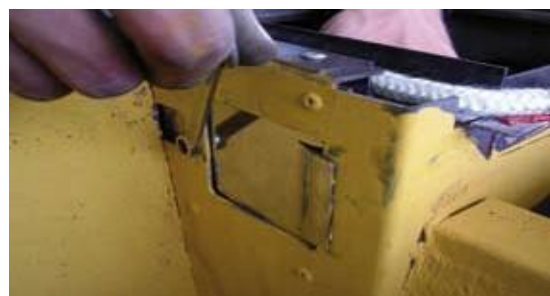
14. Ta bort täckplåten till den vänstra öppningen med hjälp av en gaffelnöckel på 8 mm och en hylsnöckel.
