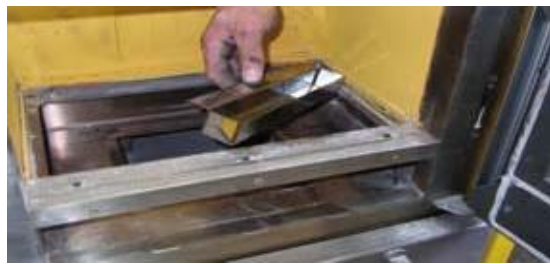
8. Vrid rökgaskanalens förslutningshölje 180° och positionera det i det vänstra fästet.
