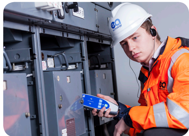
UltraTEV Detector 2 - ultrasonic mode
