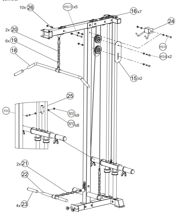
Diese Schritte sind für die Befestigung der Arme, Halterungen und Griffe notwendig.
