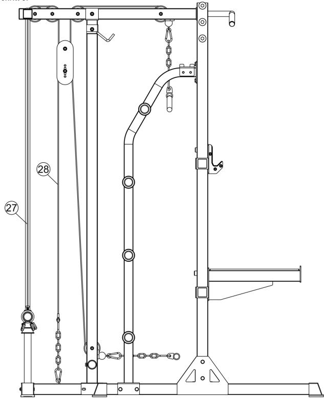
Diese Abbildung zeigt die Führung der Kabelzüge (27) & (28).
