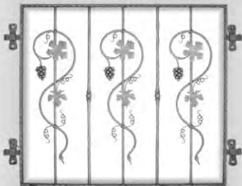
Fenstergitter Nr. 2318 Krone Zierstab Nr. 22318 Zierstab Nr. 22370 Gitterhalter Nr. 44904
