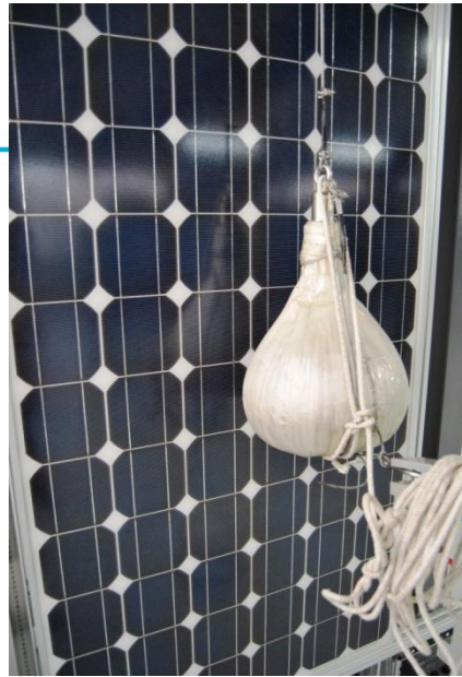
Module Breakage Test
