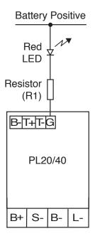
Fig. 7.5.7A - Alarm Wiring
