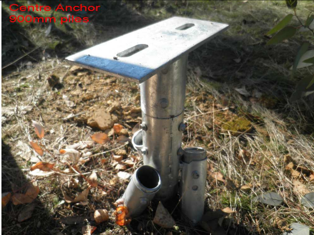
Anchor Test 900mm Piles 2000KG Load
