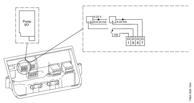
Fig. 2 Wiring diagram
