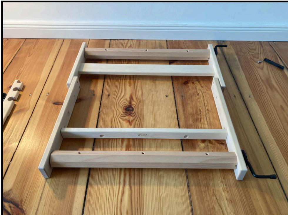
**Schritt 8:** Jetzt müssen das untere und das obere Gerüst über den Webkamm-Halter verbunden werden. Dazu muss dieser sowohl rechts als auch links am Übergang angeschraubt werden.
