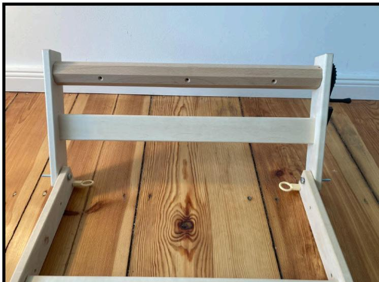
**Schritt 9:** Setze den Webkamm-Halter ein und nutze die schwarze Schraube zum Justieren. Ziehe den gelben Stecker, um das obere Gerüst bewegen bzw. einklappen zu können.
