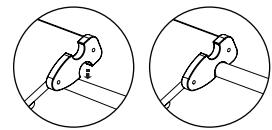
Da bi zagotovili varno in stabilno povezovanje ločenih piklerjevih elementov, preverite, ali je vsak povezovalni kavelj varno nameščen na prečko in se ne premika.
