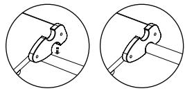
個々のPiklerユニットが安全かつ安定的につながるようにするために、各コネクターフックがよじ横桟に確実に固定され、ずれないことを確認してください。
