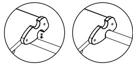
Aby zapewnić bezpieczne i stabilne połączenie pomiędzy oddzielnymi jednostkami Pikler, należy sprawdzić, czy każdy hak łączący jest pewnie zamocowany na szczeblach i nie przesuwa się.
