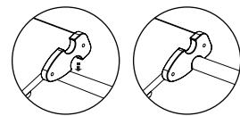
Per garantire una connessione sicura e stabile tra unità Pikler separate, controllare che ogni gancio di collegamento sia montato saldamente su un piolo di salita e non si sposti.
