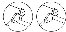
Om een veilige en stabiele verbinding tussen afzonderlijke Pikler elementen te waarborgen, moet u controleren of elke verbindingshaak stevig over een klimtrede heen is bevestigd en niet verschuift.
