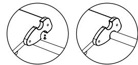
Para garantizar un ensamblaje seguro y estable entre los diferentes elementos Pikler, compruebe que cada gancho de conexión esté bien colocado sobre un peldaño y que no se desplace.
