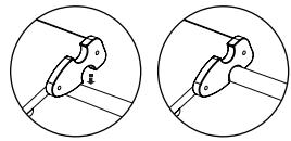
Um eine sichere und stabile Verbindung zwischen den einzelnen Pikler-Geräten zu gewährleisten, stellen Sie sicher, dass jeder Verbindungshaken sicher über einer Sprosse angebracht ist und sich nicht verschiebt.
