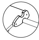
Abyste zajistili bezpečné a stabilní spojení mezi jednotlivými jednotkami systému Pikler, zkонтrolujte, zda jsou všechny spojovací háčky bezpečně nasazeny na příčku a zda se neposouvají.
