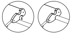
Um eine sichere und stabile Verbindung zwischen den einzelnen Pikler-Geräten zu gewährleisten, stellen Sie sicher, dass jeder Verbindungshaken sicher über einer Sprosse angebracht ist und sich nicht verschiebt.
