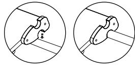
個々のPiklerユニットが安全かつ安定的につながるようにするため、各コネクターフックがよじ登り棧に確実に固定され、ずれないことを確認してください。
