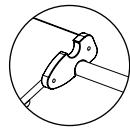
Da bi zagotovili varno in stabilno povezovanje ločenih piklerjevih elementov, preverite, ali je vsak povezovalni kavelj varno nameščen na plezalno prečko in se ne premika.
