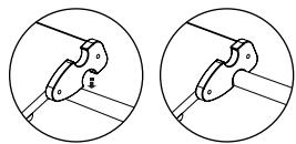
Om een veilige en stabiele verbinding tussen afzonderlijke Pikler elementen te waarborgen, dient u te controleren of elke verbindingshaak stevig over een klimtrede is bevestigd en niet verschuift.
