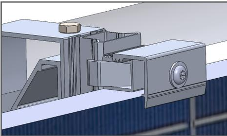
Obere Modulklammer an Modul schieben und fixieren.
