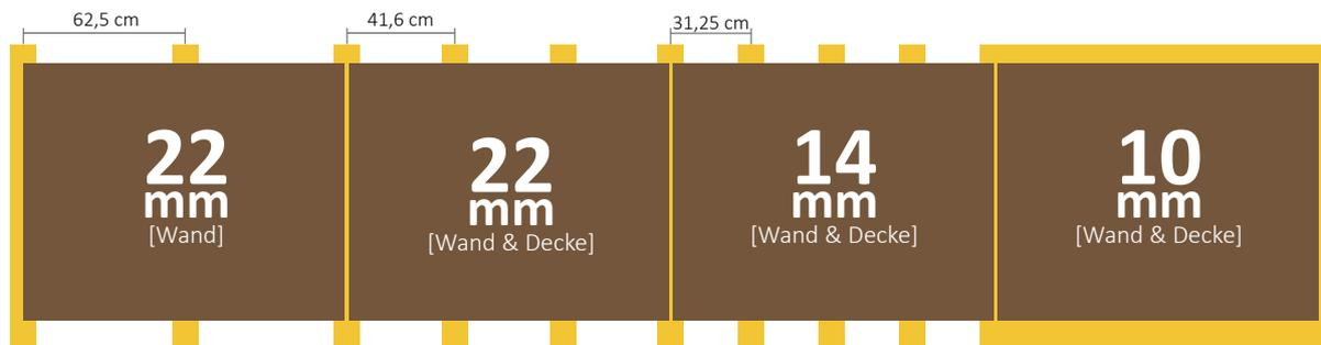
**Darstellung der unterschiedlichen Achsabstände und Unterkonstruktionen** für die empfohlene Montagerichtung der 3 Lehm- oder Leichtlehm-Platten-Typen
