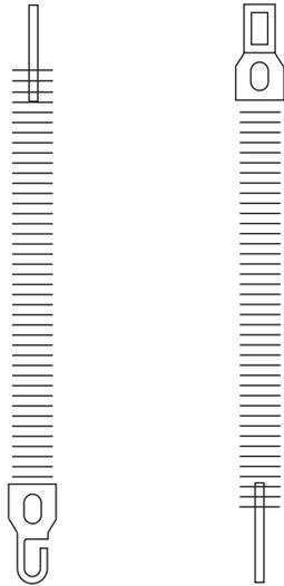
Die Plattenrichtung muss zwischen dem oberen und unteren Ende um 90 Grad entgegengesetzt sein.
