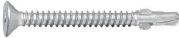
Figure 4.4 – Vis en acier galvanisé pour ossature métallique SFS Intec : SC3/25-PH2-4,8 x 35 ; Etanco : Wingteks/Zn 4,8 x 35
