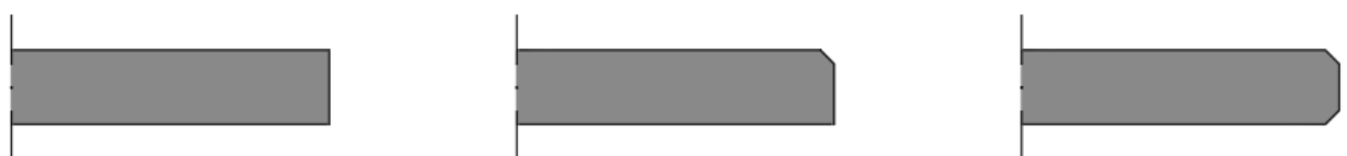
Figure 2.122 – Usinage possible des arêtes du panneau Viroc
