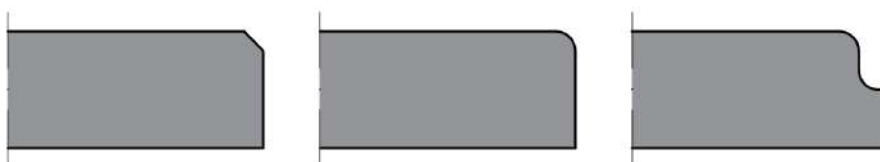
Figure 1.11 – Usinage des arêtes. Biseau, boulonnage et fraisage.
