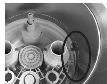
Figura 19 Conexión a la lengüeta de empalme sobre la cubierta de acero inoxidable
