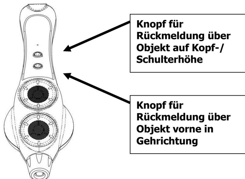
**Sensorengehäuse – der gebogene Teil des Griffs auf der Seite, an der der Stock befestigt wird.**
