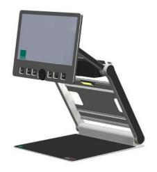
Pivotez la caméra vers le bas en la positionnant vers vous. La caméra s'enclenchera en position.
