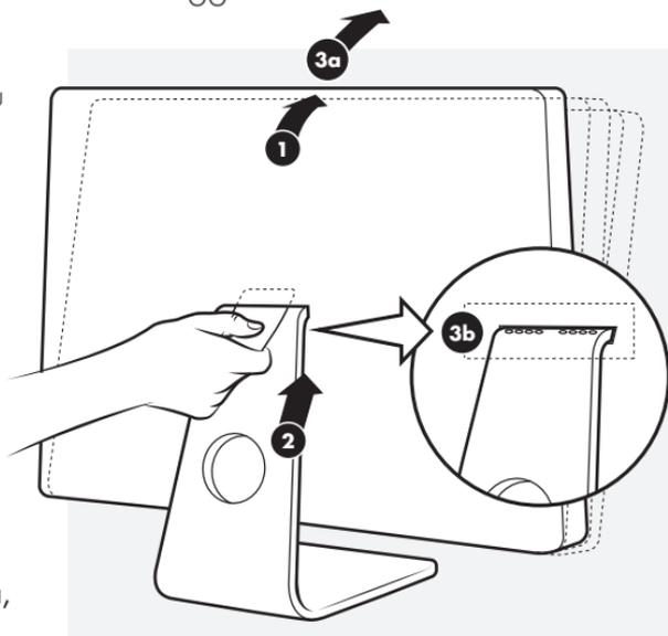
1. Ruotare il display in avanti fino a fine corsa, quindi tenerlo fermo.
