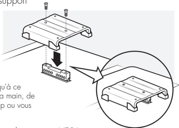
REMARQUE : serrez les vis jusqu'à ce qu'elles soient aussi serrées, à la main, de chaque côté. Ne serrez pas trop ou vous pourriez plier le support.
