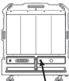
Remplir le réservoir ou fixer le tuyau d'eau. Nous recommandons d'utiliser le raccord pour tuyau avec une vanne d'arrêt automatique.
