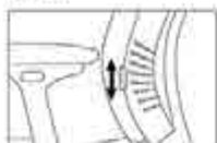
Altura do apoio lombar (opção)
