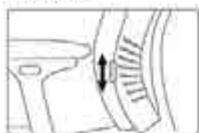
Altezza del sostegno lombare (opzione)
