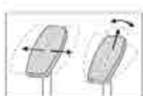
Înălțimea, adâncimea, pivotul și adâncimea cotierelor (opțional)
