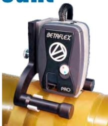
**DOCUMENTA DESGASTE Y DAÑOS DE PLANCHA MIENTRAS AÚN ESTÁ EN LA PRENSA.** El cabezal sensor del Betaflex Pro se puede colocar en este dispositivo. Estabilizando el sensor sobre un cilindro estacionario de plancha para mediciones en 3D. Las muestras de impresión en rollo también pueden ser analizadas en una bobina estacionaria sobre una barra de volteo o sobre una superficie plana de la prensa.
