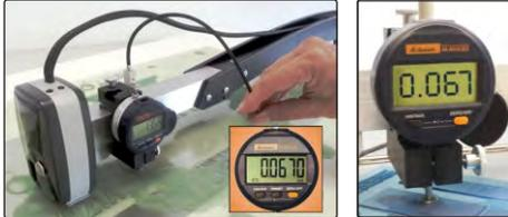
**Mida el calibre de la placa, el relieve de las placas de ablación térmica, acuosa, solvente y directa con el micrómetro digital FlexiGage para agregar los información directamente a La base de datos con el software FlexoEyePlus.**
