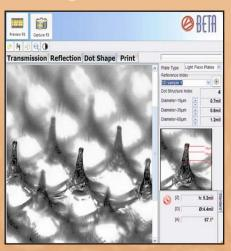
Las imágenes en 3D son la única manera de calibrar y controlar las técnicas de tramado de alta definición. Las planchas de fotopolímero y las de elastómero pueden ser fácilmente observadas, analizadas y comparadas con los estándares de la compañía impresora. El indicador de PASA/FALLA simplifica el trabajo de los empleados de producción mientras que los datos detallados de medición están
