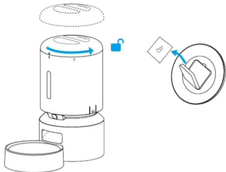
3. Ziehen Sie die Kerben auf beiden Seiten etwas nach außen und dann nach oben, um den Futtertank zu entfernen.
