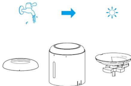
6. Bringen Sie sie wieder an der Maschine an. Drehen Sie den Tanksockel im Uhrzeigersinn, bis er einrastet.
