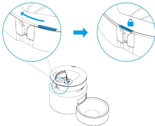
7. Dann montieren Sie den Tank und Deckel.
