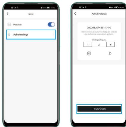
**Hinweis:** Das Gerät kann nur die letzte Aufnahme speichern. Wenn eine neue Aufnahme fertig ist, wird die alte Aufnahme automatisch gelöscht.
