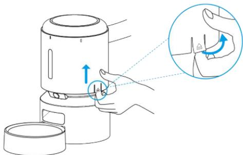
4. Drehen Sie gegen den Uhrzeigersinn, um den Tankboden zu entfernen.
