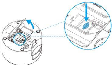
2) Setzen Sie die TF-Karte in der angezeigten Richtung ein. Schieben Sie es hinein, bis es einrastet.
